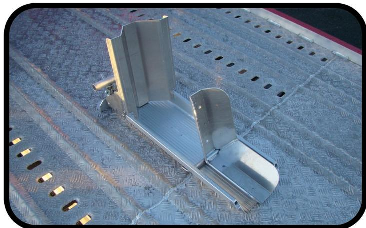
\* Cale spéciale moto avec un sabot pour emboîtement de la roue et support sous le plateau.
