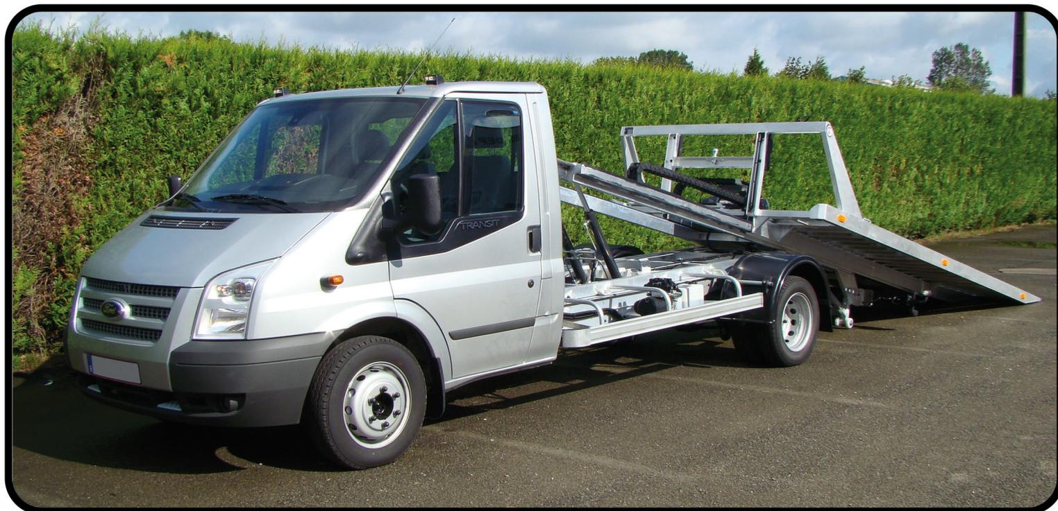
Faux-châssis - Basculeur - Plateau 100% Aluminium soudé - Longueur 4900 mm x Largeur : 2100 mm.
