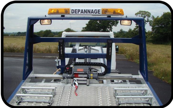
\* Roll-bar surélevé, type FLYER avec rampe lumineuse CODE 3 et rappel des feux.
