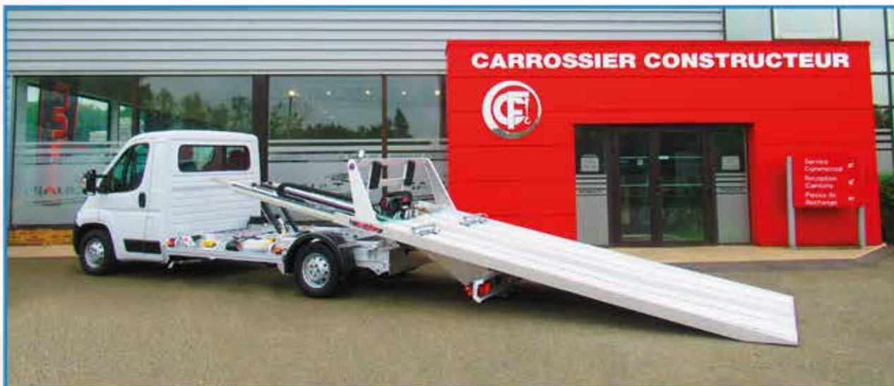
Faux-châssis - Basculeur - Plateau 100% Aluminium soudé
