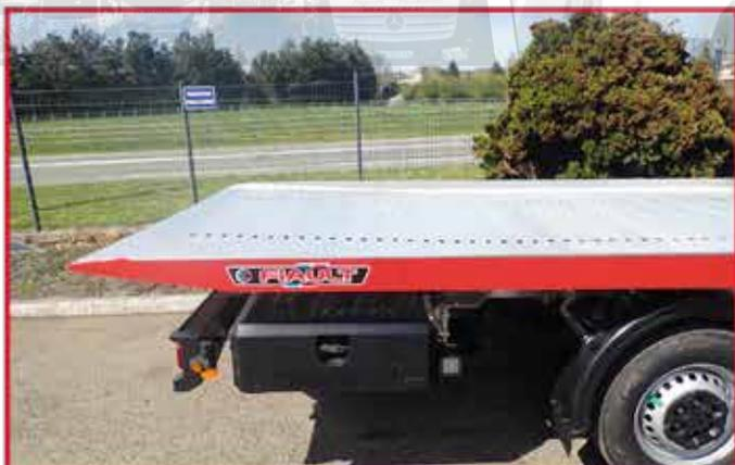
\* Protections inox sur le dessus des rives du plateau avec plats 10mm.
