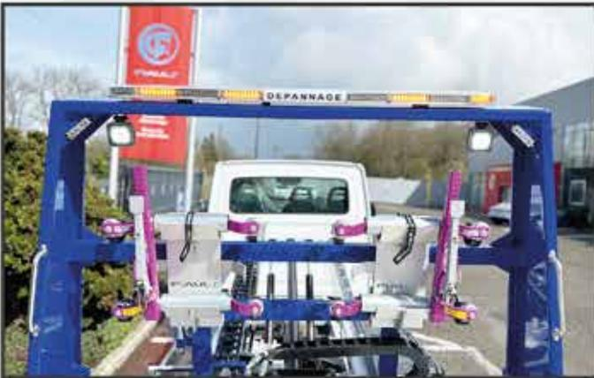
\* Roll-bar surélevé type FLY avec rampe lumineuse à leds et rappel des feux intégrés.
