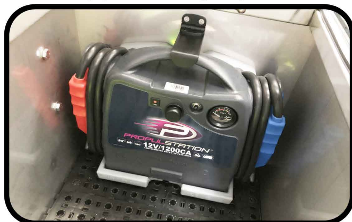
* Un booster propulstation 12V avec station de recharge installée dans un coffre à outils
