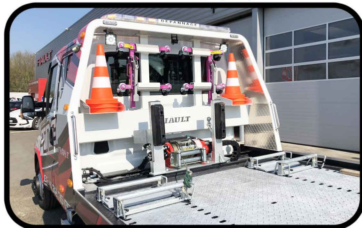
* Déplacement transversal hydraulique du treuil 3T6 ou 4T5, boule amovible et habillage alu du FLY
