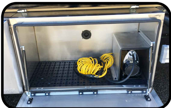
* Installation d'un compresseur d'air avec flexible et manomètre de pression
