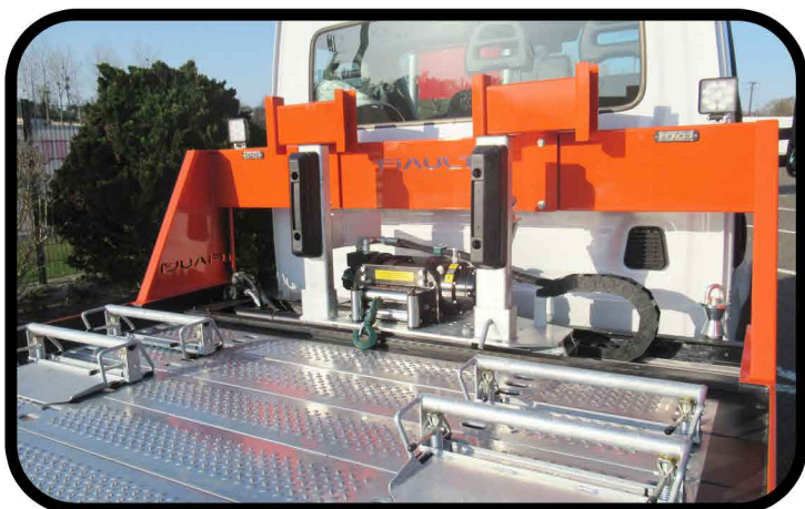
* Roll-bar avant standard avec butoirs et supports pour chariots de remorquage
