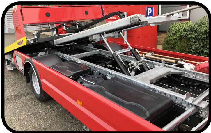
* Coffres à outils en polyuréthane avec ouverture par le dessus derrière les carénages aluminium
