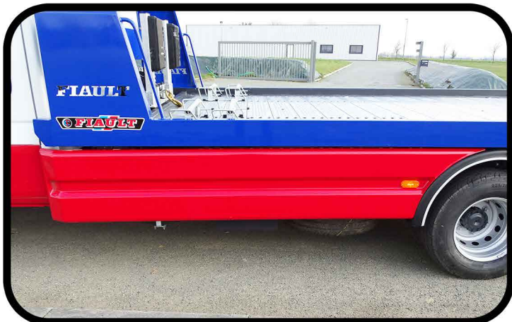
* Carénage stylisé en aluminium dans l'empattement
