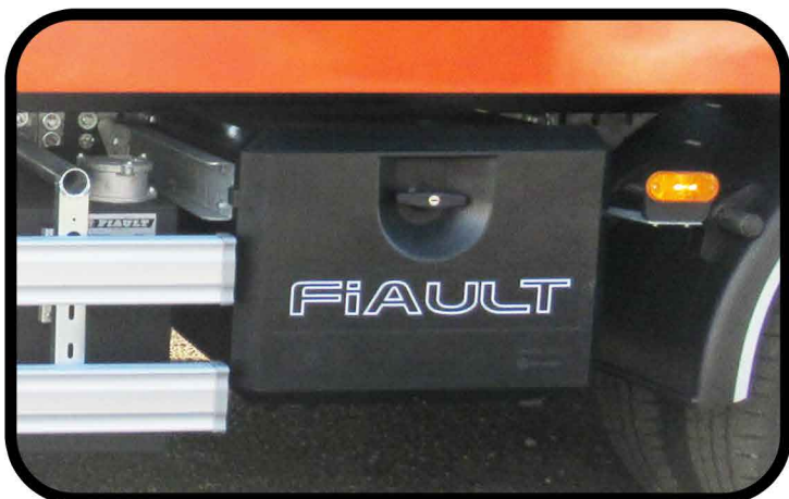
* Coffre à outils anti-chocs en polyuréthane
