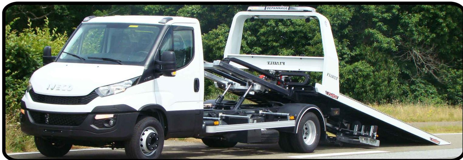
Coulissement du plateau sur patins de friction en nylon. Commande radio intégrale plateau - treuil.
