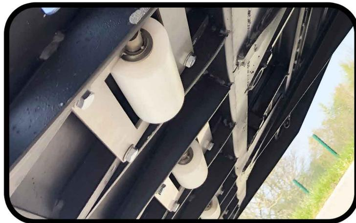
\* Deux rouleaux d'appui à l'arrière sous le plateau
