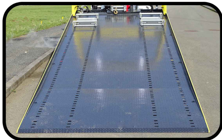
* Plancher tôles à larmes peint ou galvanisé, bords de rives avec un plat 10mm
