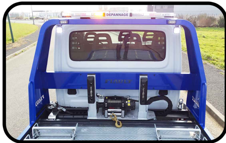
* Déplacement transversal hydraulique du treuil 4T5 ou 7T2 et boule d'attelage amovible
