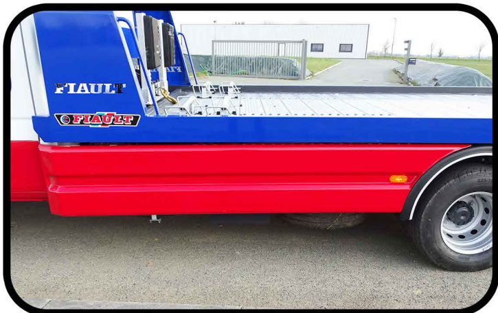
* Carénage stylisé en aluminium dans l'empattement
