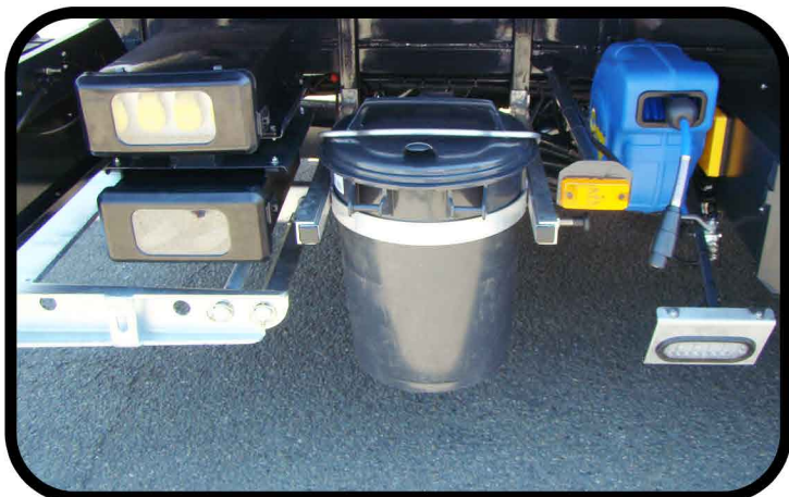
* Enrouleur pneumatique, bac à sable coulissant, extincteurs, prises de démarrage et éclairage de ronde
