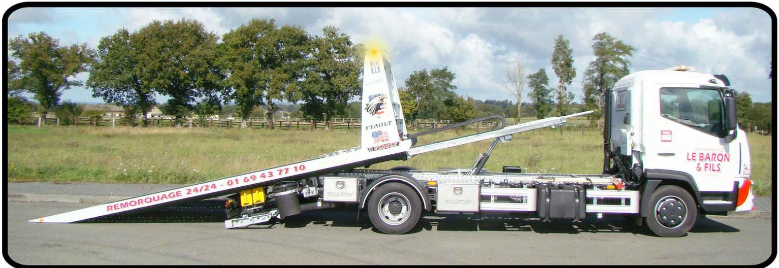
Plateau basculant-coulissant en acier galvanisé anti-dérapant épaisseur 3 mm ou en aluminium.
