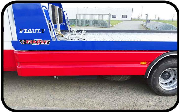
**\* Carénage stylisé en aluminium dans l'empattement**
