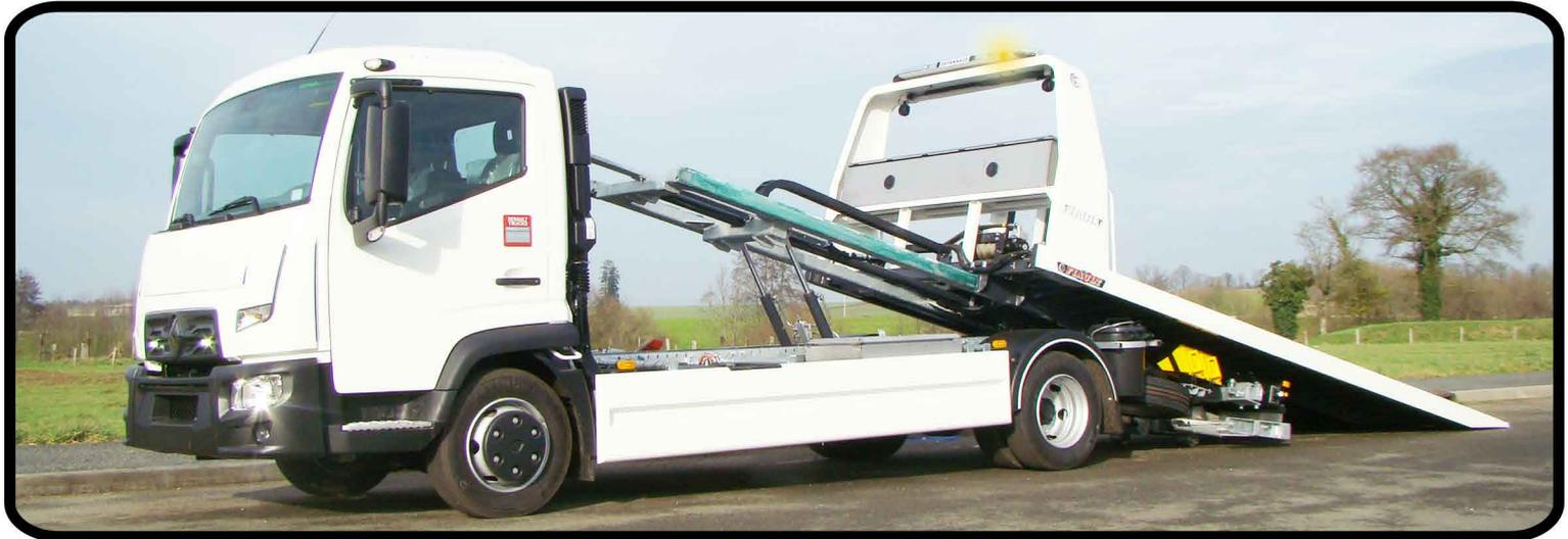
Capacité technique du plateau : 3000 Kg - Longueur : 5000 à 5500 mm - Largeur : 2200 mm.
