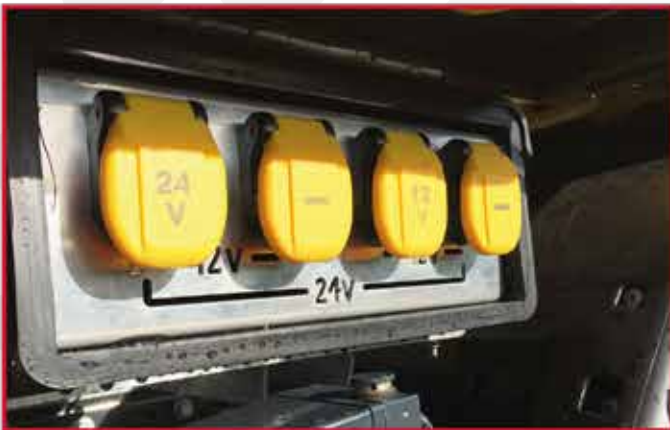
* Deux câbles de démarrage avec deux prises 12V et 24V dans un coffre fermé.
