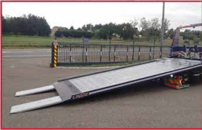
* Deux rampes arrières de correction d'angle en 1 partie en tôles renforcées longueur 1200mm.
