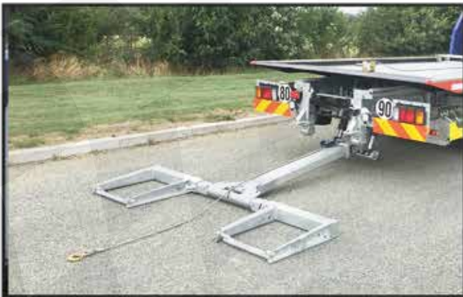
* Treillage sur le panier par le treuil du plateau ou treuil hydraulique fixé directement sur le panier.
