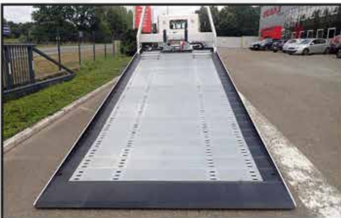
- Plancher avec éléments modulaires GALVANISES type caillebotis avec bords de rives plats 10mm.
