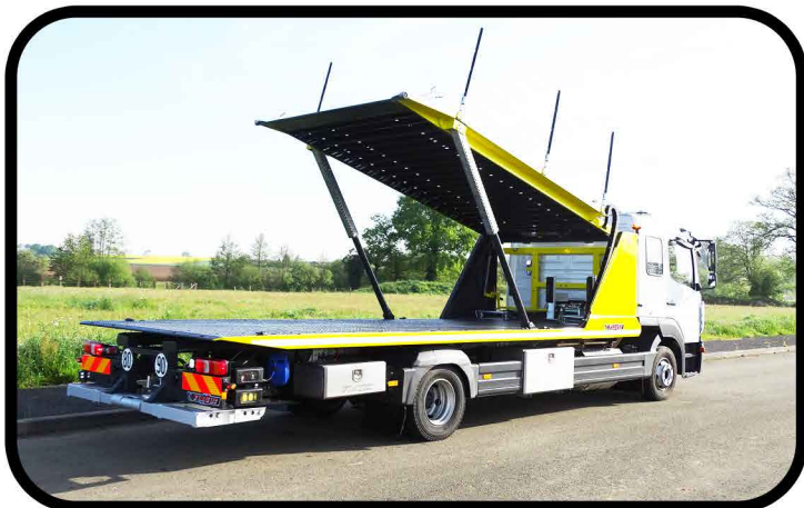
* Demi étage type 1 : élévation de l'AV par 2 galets dans 2 glissières obliques et élévation de l'AR par vérins
