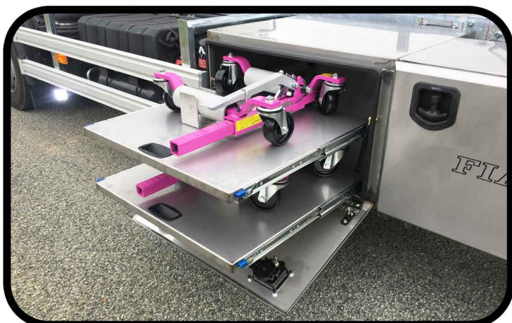
* Un coffre de rangement en inox avec tiroirs coulissants pour deux chariots à roues pivotantes
