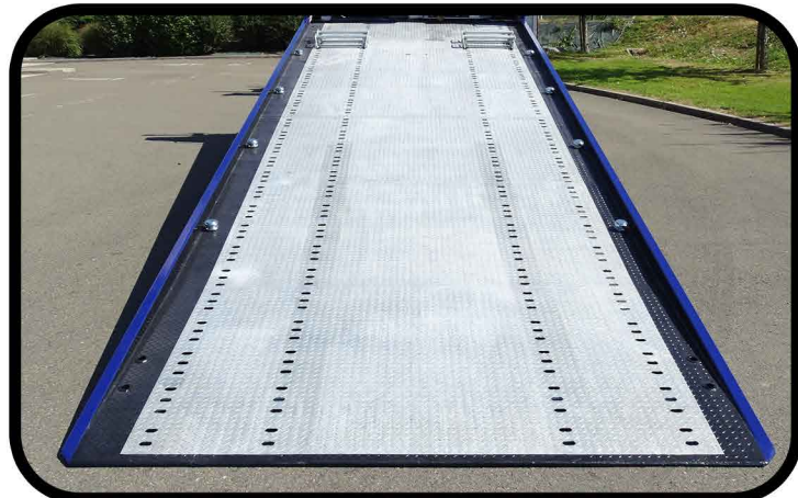
* Plancher en tôles renforcées à LARMES GALVANISE à chaud ép. 4/6 avec bords de rives tubulaires 50mm
