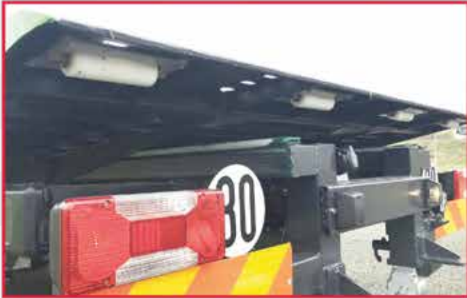
* Quatre rouleaux d'appui à l'arrière.
