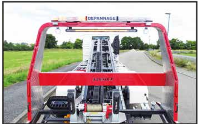
* Dix feux ROUGE à leds sur le pourtour du FLY et un bandeau de signalisation avec défilement.
