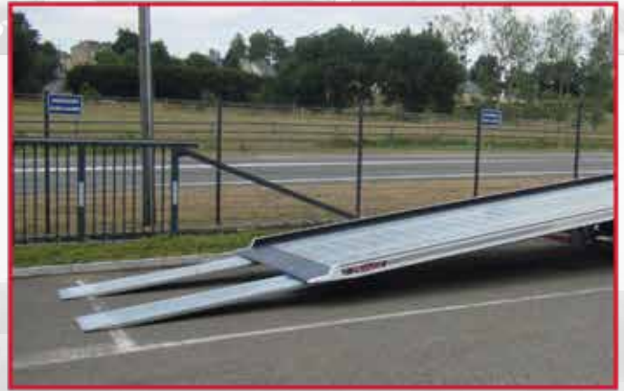
* Deux rampes arrières de correction d'angle en 1 partie en tôles renforcées longueur 1800mm.
