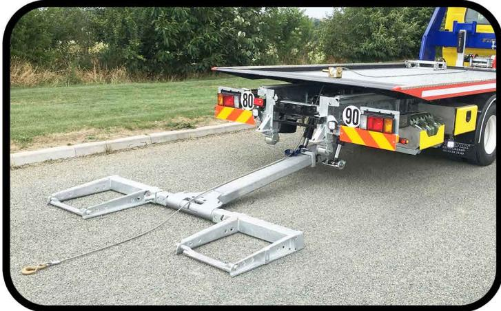
**\* Treuillage sur le panier par le treuil du plateau ou treuil hydraulique fixé directement sur le panier**
