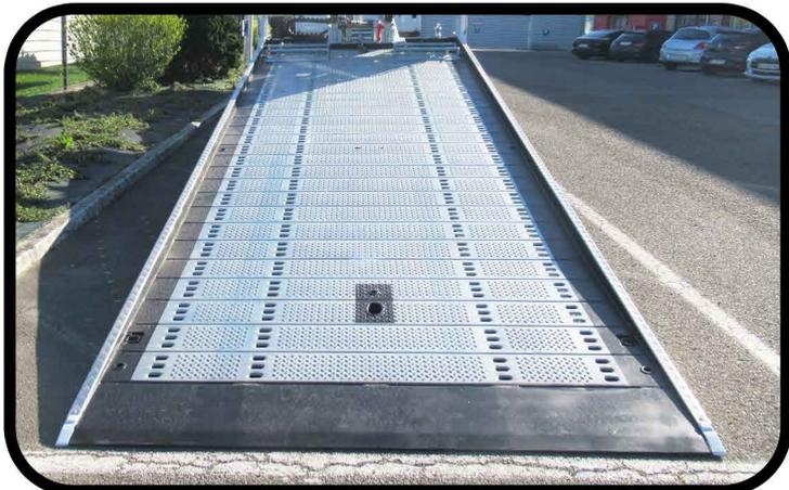
**- Plancher avec éléments modulaires GALVANISES type caillebotis avec bords de rives tubulaires 50mm**
