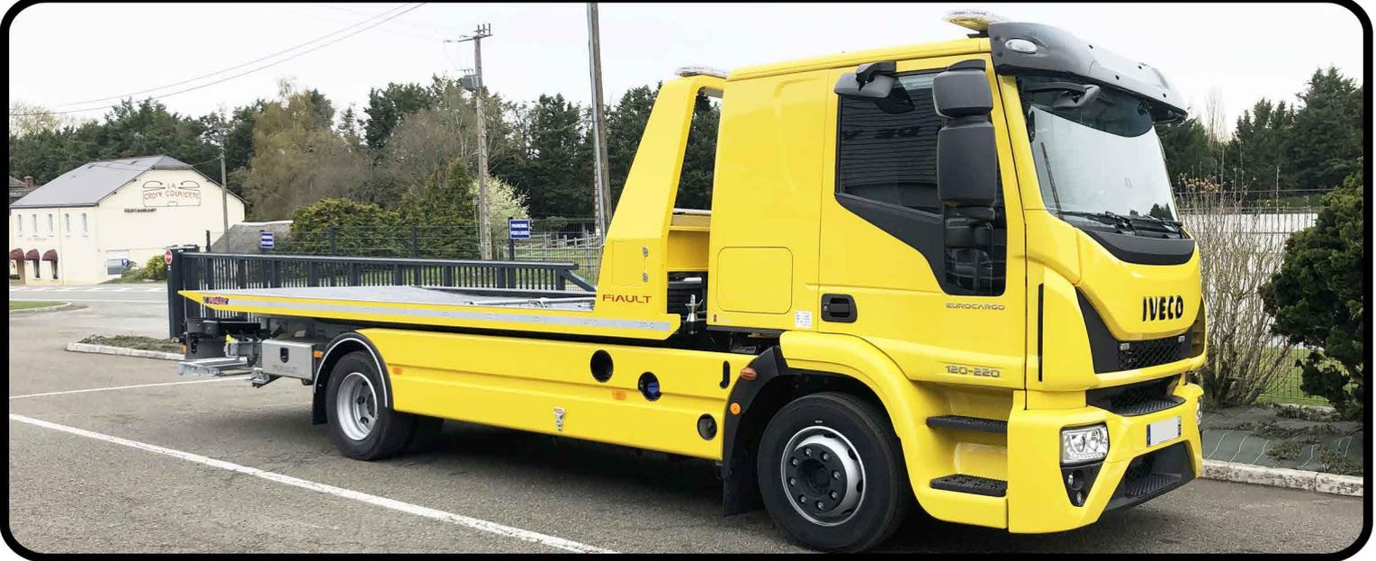
Capacité technique du plateau : 6500 Kg - Longueur : 5000 à 9000 mm.
