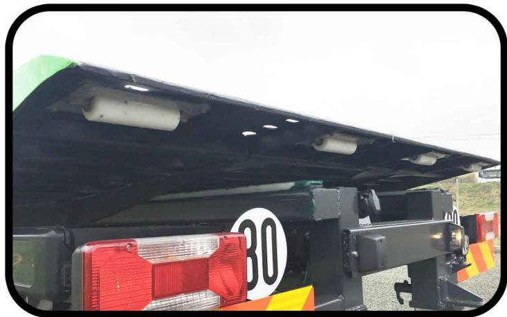
\* Quatre rouleaux d'appui à l'arrière sous le plateau
