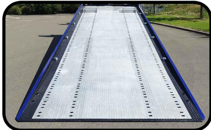
**\* Plancher en tôles renforcées à LARMES GALVANISE à chaud ép. 4/6 avec bords de rives tubulaires 50mm**
