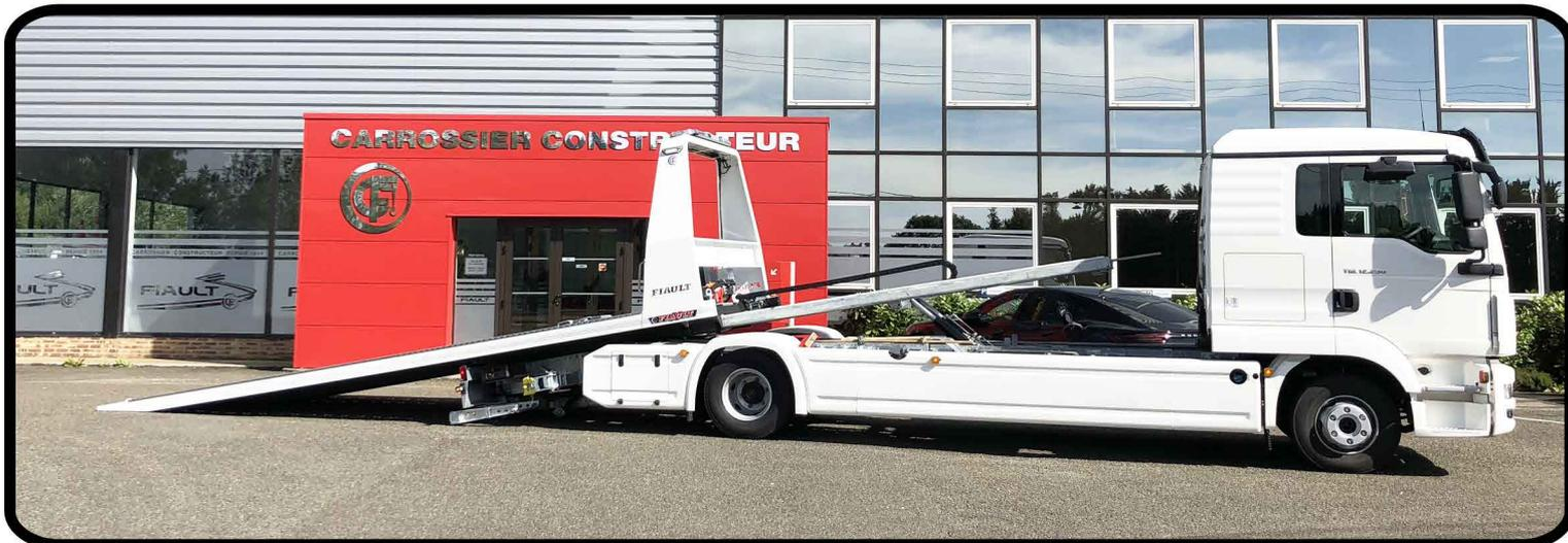
Capacité technique du plateau : 6500 Kg - Longueur : 5000 à 9000 mm.
