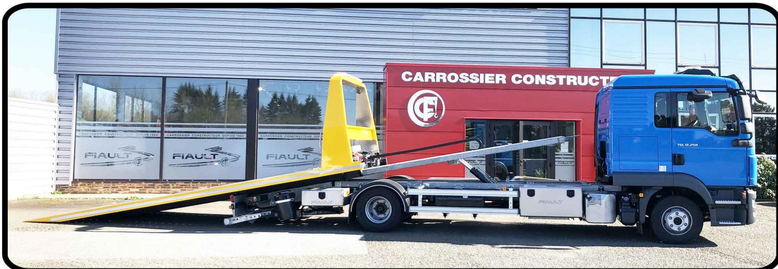
Plateau basculant-coulissant en acier anti-dérapant épaisseur 4/6 mm. Commande radio intégrale plateau - treuil.
