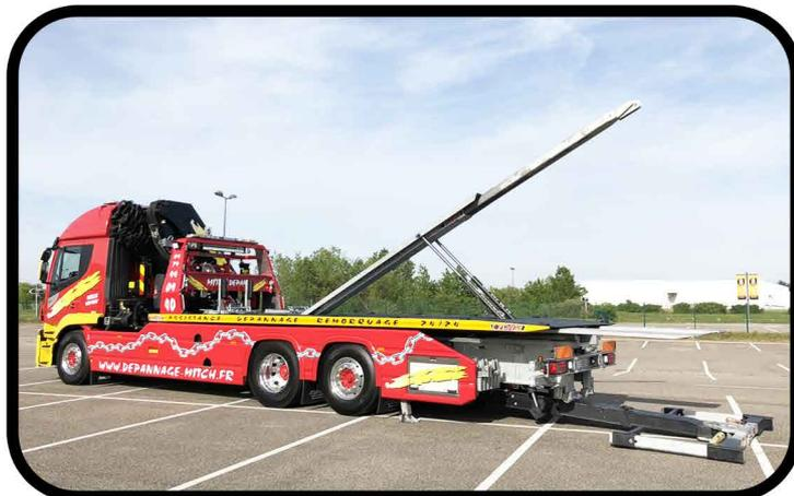
\* Flèche hydraulique CRANELIFT, capacité 2T
