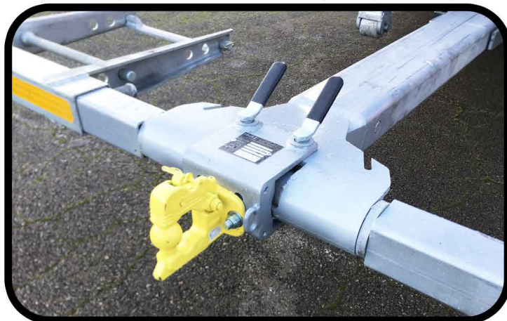
* Chape + boule adaptable sur panier de remorquage
