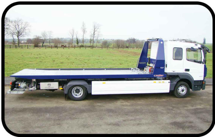
* Carénage stylisé de l'empattement seul en polyester
