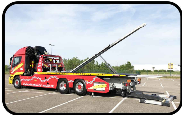
* Flèche hydraulique CRANELIFT, capacité 2T
