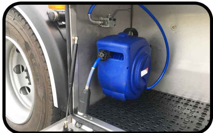
* Un enrouleur pneumatique avec tuyau dans un coffre à outils
