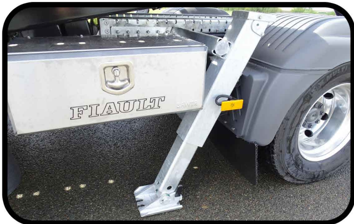
* Bêches hydrauliques à patins pivotants avec doigts d'ancrage au sol
