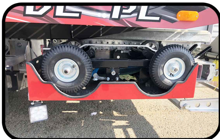
* Deux chariots de remorquage à roues fixes gonflables type FOURRIERE avec support
