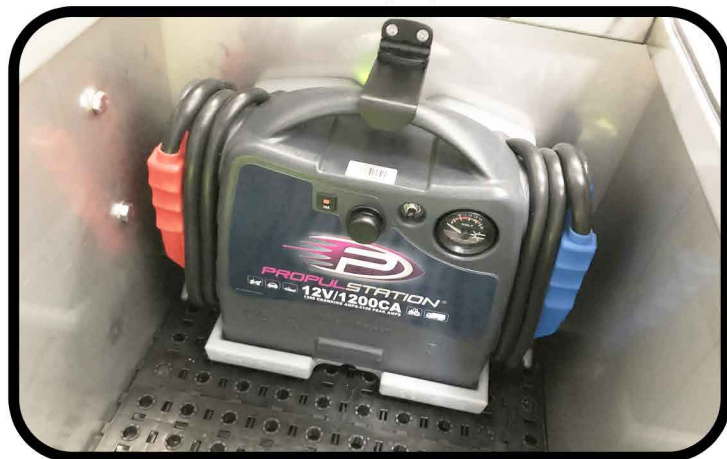
* Un booster propulsion 12V ou 12-24V avec station de recharge installé dans un coffre
