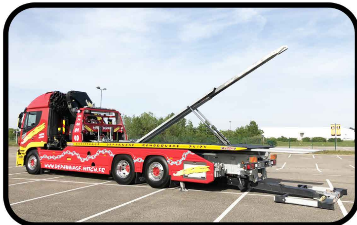
* Flèche hydraulique CRANELIFT, capacité 2T
