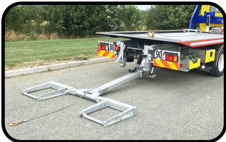
* Treuillage sur le panier par le treuil du plateau ou treuil hydraulique fixé directement sur le panier
