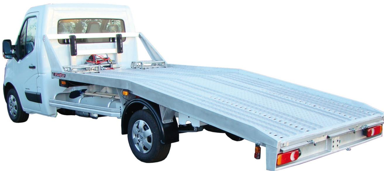
Plancher et rampe en tôles d'aluminium de 3 mm anti-dérapantes et entièrement soudées.
