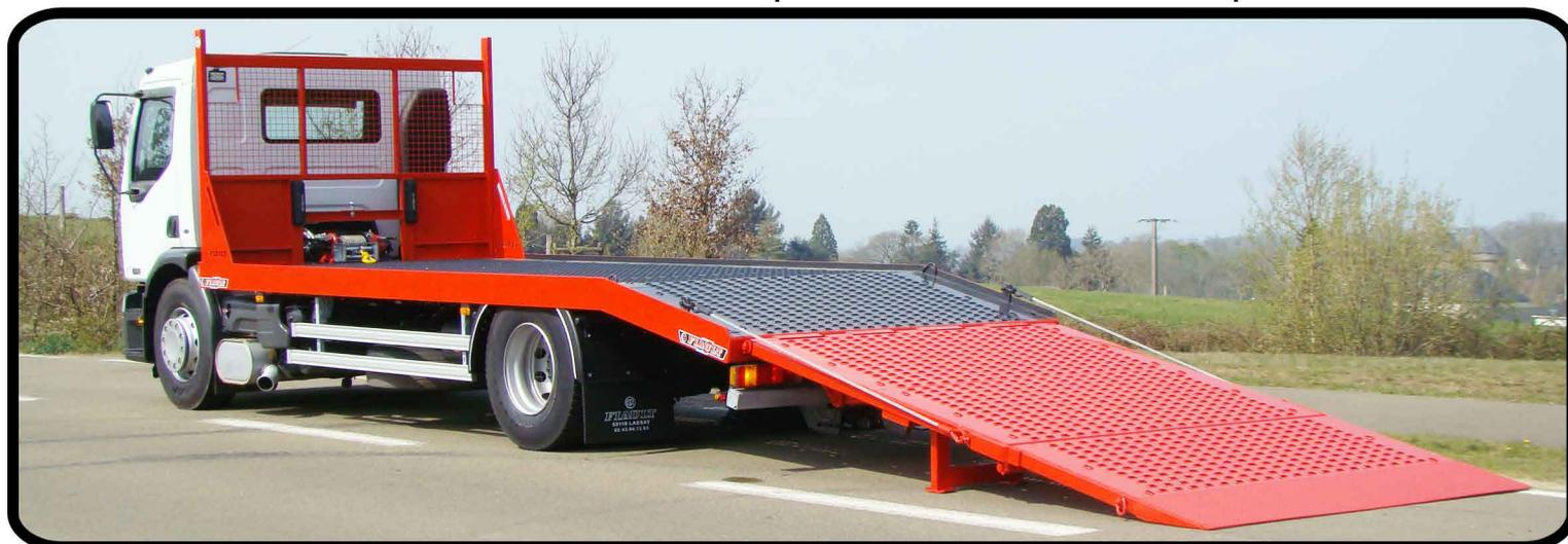
Porte à faux arrière fixe avec une grande rampe ou deux rampes articulées et réglables en largeur hydrauliquement.
