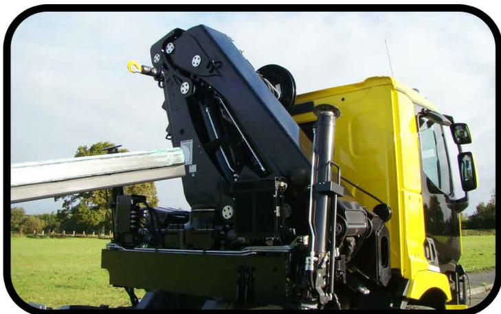
\* Fourniture et installation d'une grue hydraulique derrière la cabine
