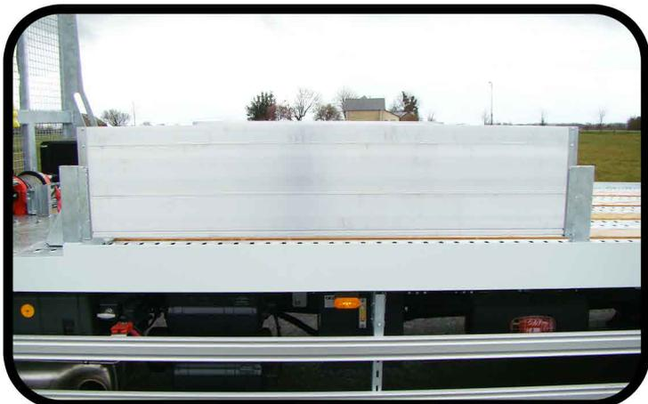
**\* Ridelles de protection gauche et droite emboîtables dans le plancher**
