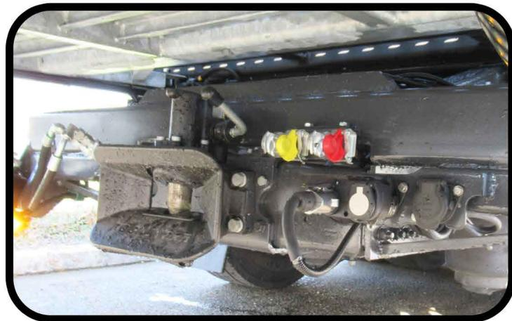
\* Un crochet d'attelage pour remorque avec anneau diam 50 installé sur une traverse fixe à l'arrière
