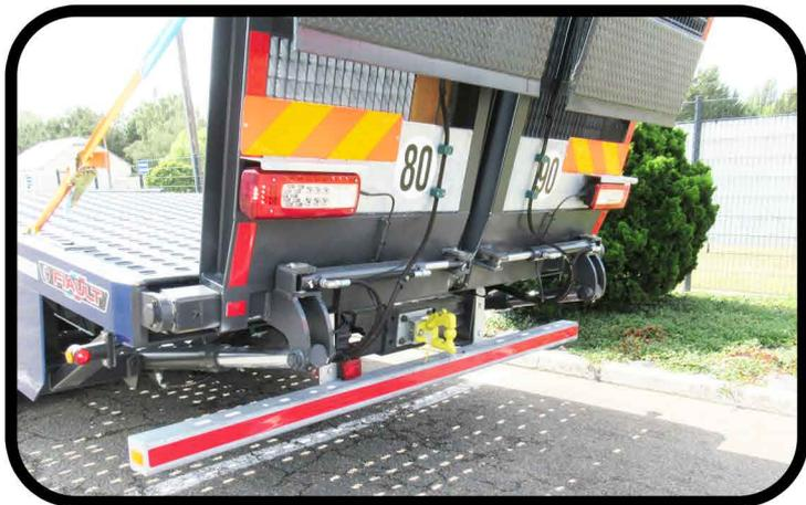
\* Un crochet d'attelage double chape + boule diam. 50 fixé à l'arrière du plateau
