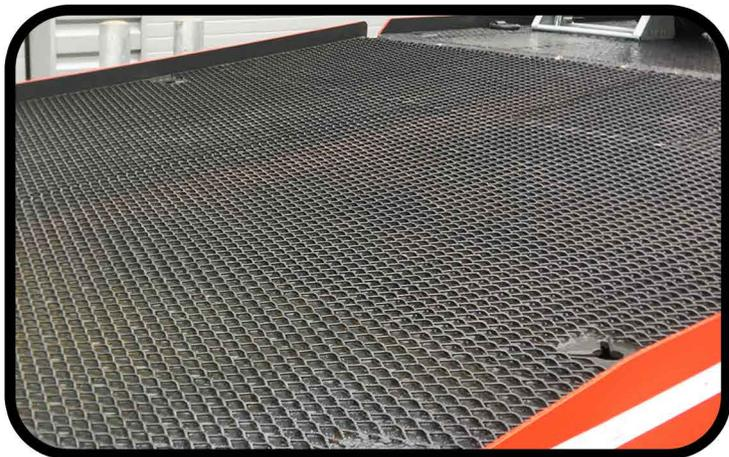
\* Métal déployé antidérapant soudé sur le porte à faux arrière fixe
