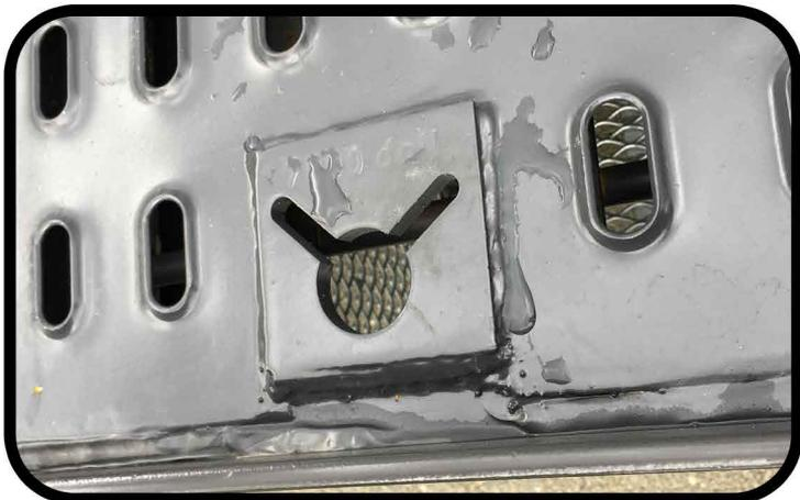
**\* Têtes d'arrimage encastées dans le plancher**
