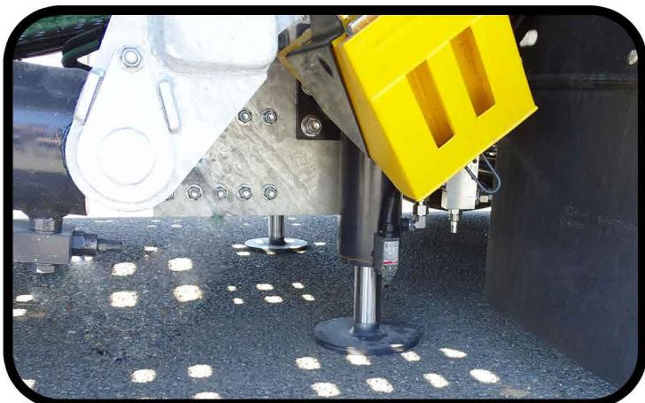
**\* Deux vérins de stabilisations avec commandes hydrauliques séparées, fixés en côté du châssis**
