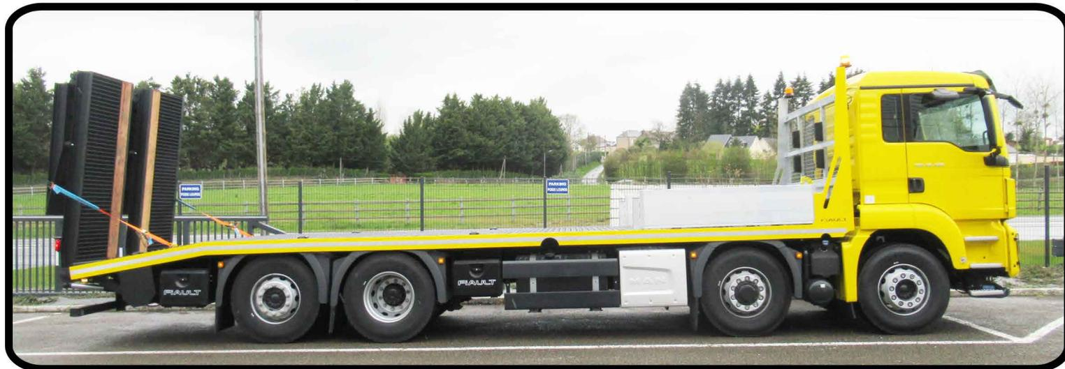
Structure en acier à haute limite élastique avec éléments GALVANISES et peints.
