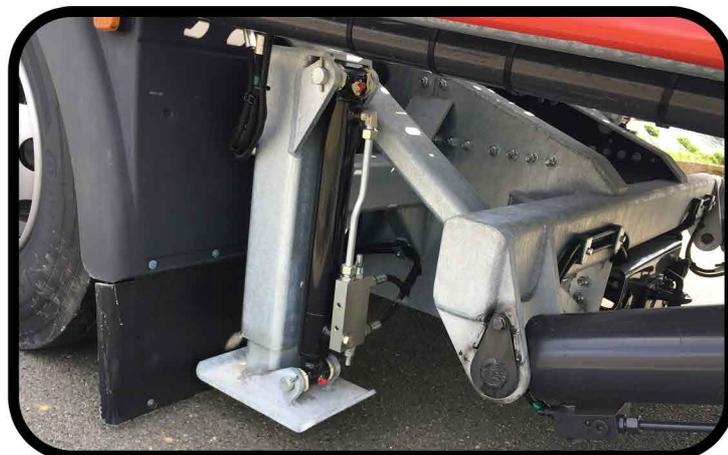
**\* Deux béquilles arrière avec commandes hydrauliques séparées (largeur d'appui 2500 mm)**
