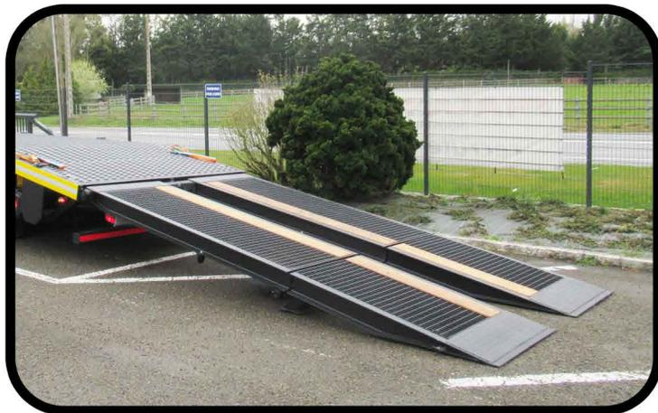
\* Deux rampes séparées avec 2 vérins hydrauliques pour le rapprochement ou l'écartement en largeur
