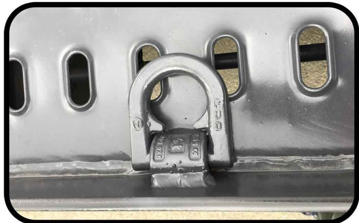
**\* Anneaux d'arrimage 7T articulés et soudés sur le plancher**
