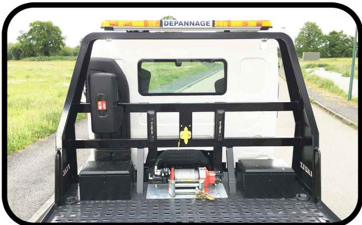
**\* Roll-bar avant type FLY surélevé au niveau de la cabine avec joues latérales stylisées et rampe lumineuse**
