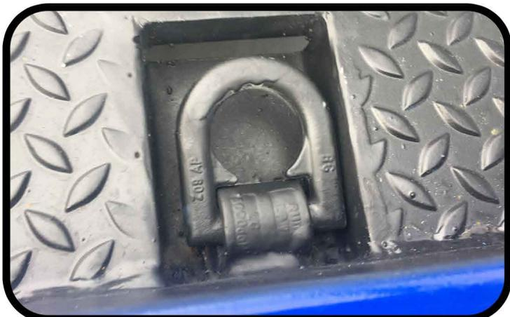
**\* Anneaux d'arrimage 7T articulés et encastés dans le plancher**
