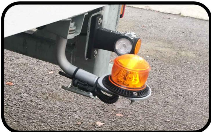
\* Deux gyrophares à leds installés sur potences pivotantes manuellement à l'arrière du plateau
