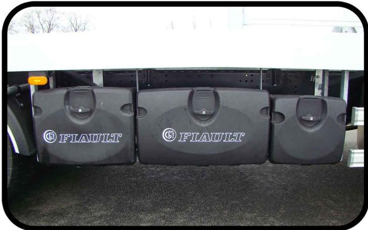
**\* Coffres de commande et de rangement anti-chocs en polyuréthane**
