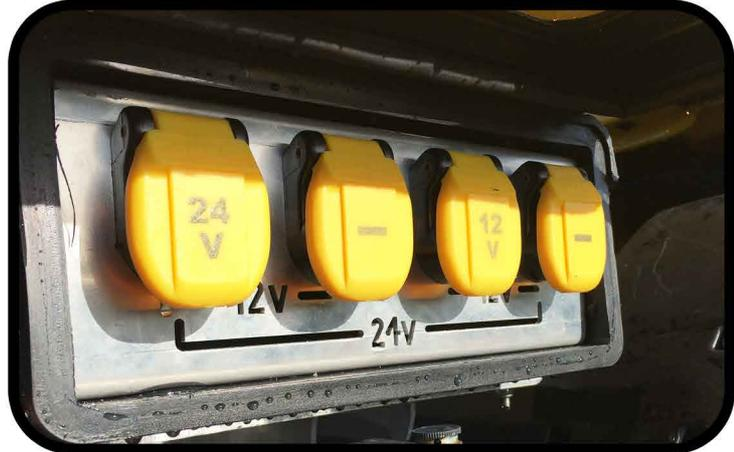
**\* Deux câbles de démarrage avec deux prises 12V et 24V en côté de l'équipement**
