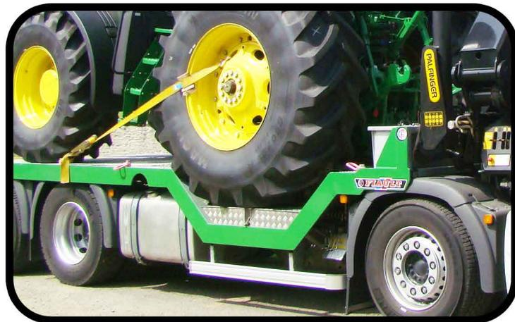
\* Adaptation de deux fosses de roues dans l'empattement avec tôles de fermeture en aluminium
