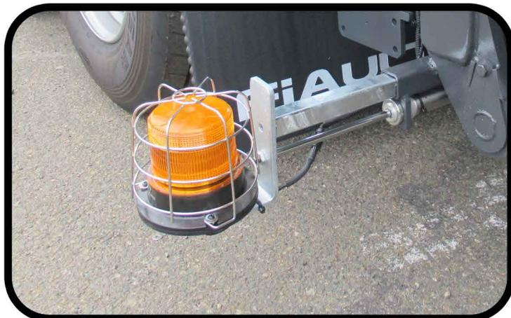
\* Un gyrophare à leds extensible par vérin pneumatique installé dans le porte à faux arrière
