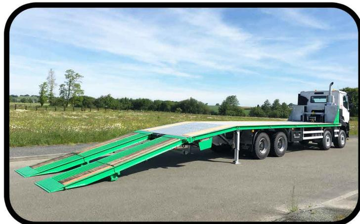
**\* Galvanisation à chaud de l'intégralité de l'équipement (faux châssis, plancher, face avant, accessoires)**
