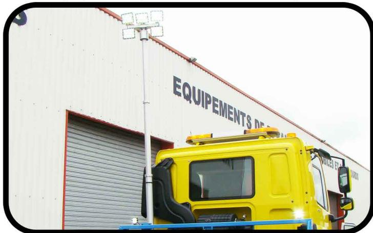
\* Un mât d'éclairage télescopique 12/24V hauteur 1,58m /3,65m avec 5 projecteurs à leds
