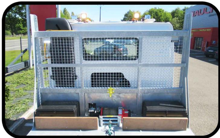
\* Roll-bar avant spécial TP avec tôle en bas et grillage de protection de cabine en partie haute
