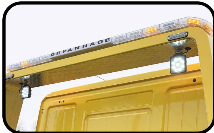
**\* Rampe de signalisation à leds avec marquage central personnalisé sur cabine ou FLY**
